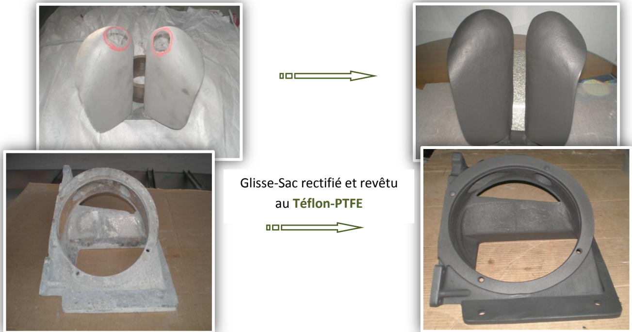
Tambour de remplissage rectifié et revêtu au Téflon-PTFE
