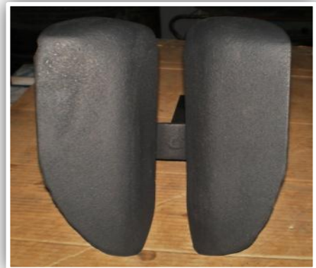
Scelle basculante rectifiée et revêtue au Téflon-PTFE
