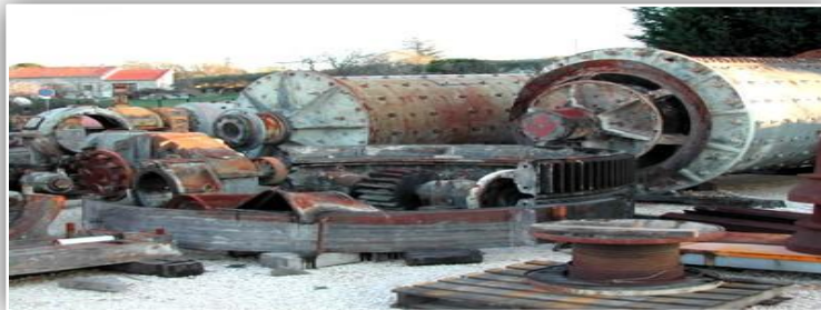
Pièces de Broyeurs à boulets détériorées
