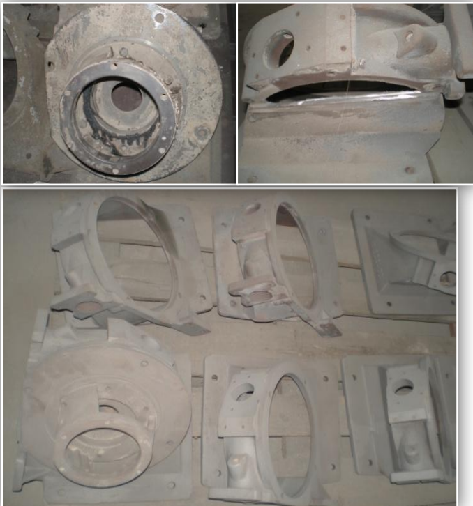
Tambours de remplissage usés
