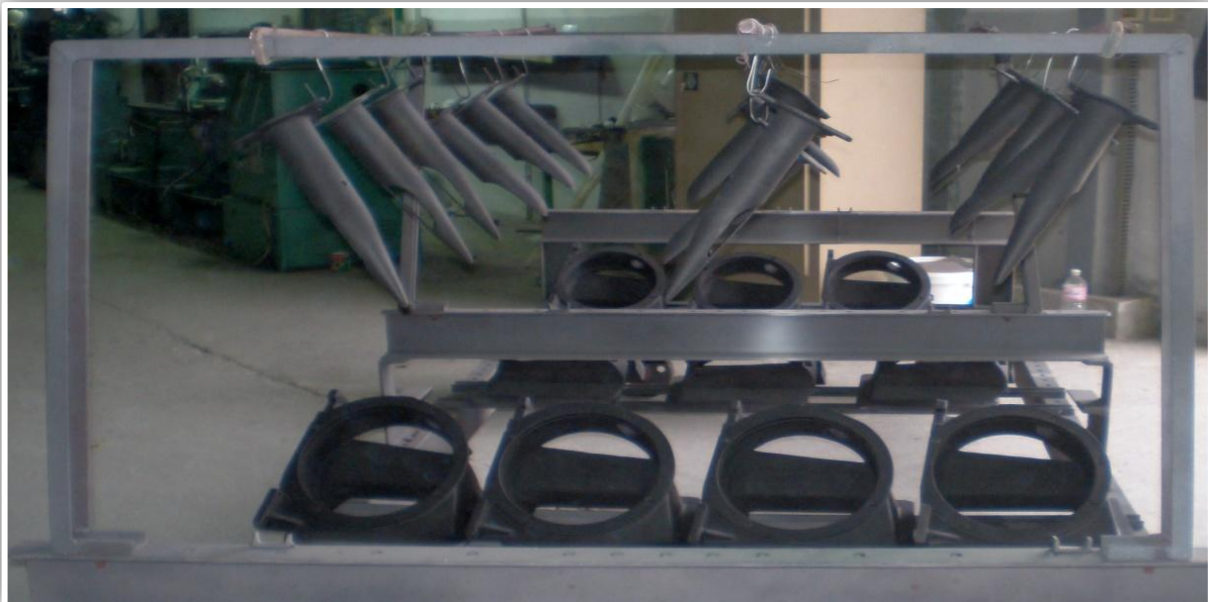
Cuillères de Goulotte rectifiées et revêtues au Téflon-PTFE
